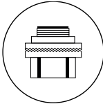
Entrada de conducto de 3/4
