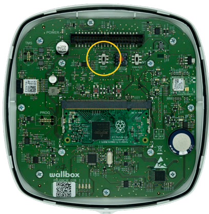
Afb. A3.1 de RS485-schakelaar instellen op “T”
