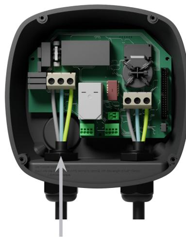
Si vous utilisez cette ouverture pour le câblage de communication, retirez d'abord le bouchon à vis. Utilisez une clé pour maintenir l'écrou de blocage intérieur tout en dévissant le bouchon à l'aide d'un tournevis à tête plate depuis le côté inférieur (extérieur) du bouchon.
