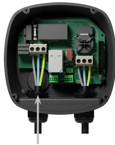
Cuando utilices esta apertura para el cableado de comunicaciones, remueve el tapón roscado antes. Utiliza una llave para sostener la tuerca de bloqueo interna a medida que desatornillas el tapón con un destornillador de cabeza plana desde la parte inferior (exterior) del tapón.
