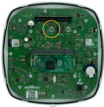
Fig. A3.1 Ajuste el interruptor RS485 a “T”
