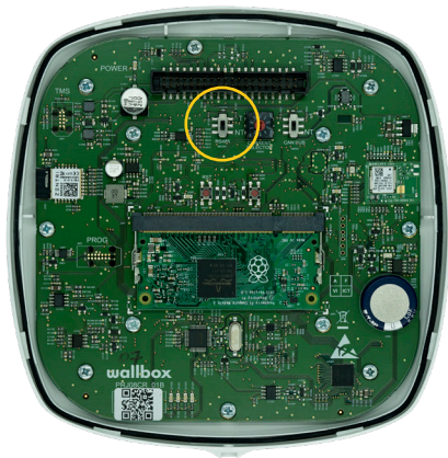
Fig. A3.1 Einstellung des RS485-Schalters auf „T“
